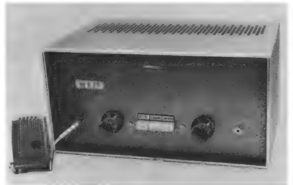
Bild 1. Der Sprach- und Modulationsverstärker MV 17. Die Frontplatte ist von links nach rechts wie folgt gegliedert: Mikrofonbuchse, Clippergrad-einsteller, Drucktastenaggregat (darüber Abstimmanzeigerröhre), Lautstärkeinsteller, Meßbuchse
